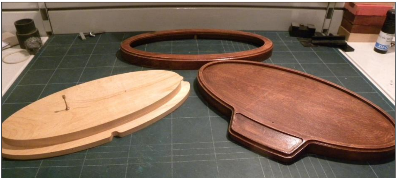
Partes mecanizadas para el fanal que contendrá el modelo.
