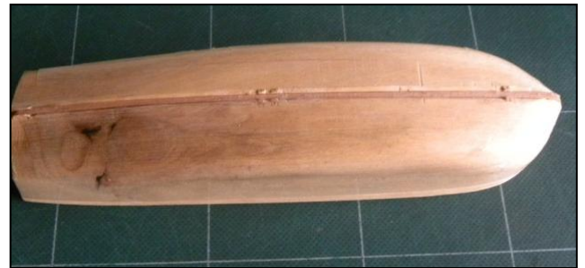
Taco de madera, también mecanizado, que sirve como molde para el armado de la chalupa
