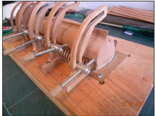
Pegado definitivo de tracas (forro externo)
