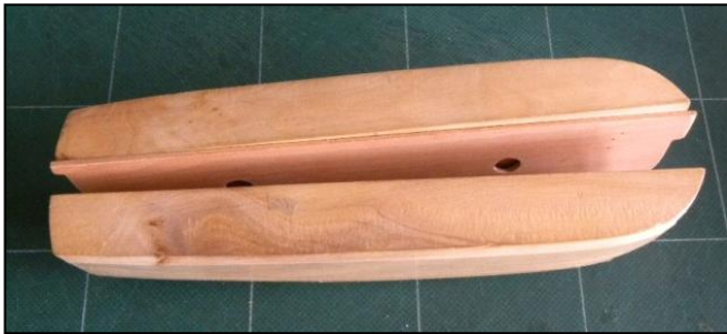
Taco de madera, también mecanizado, que sirve como molde para el armado de la chalupa
