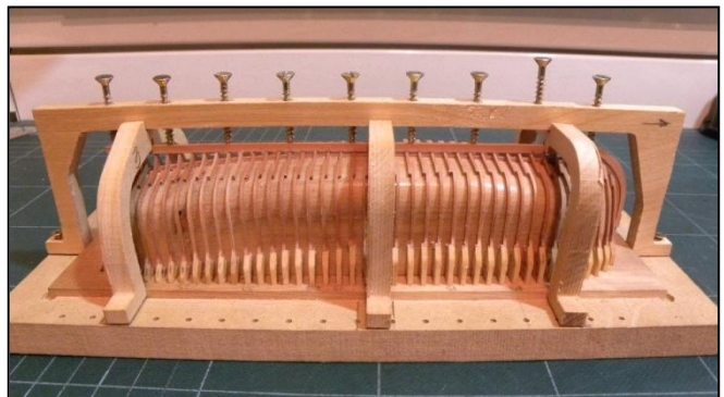
Colocación de cuadernas y quilla (Observar los dispositivos fabricados para lograr el perfecto ensamblado)
