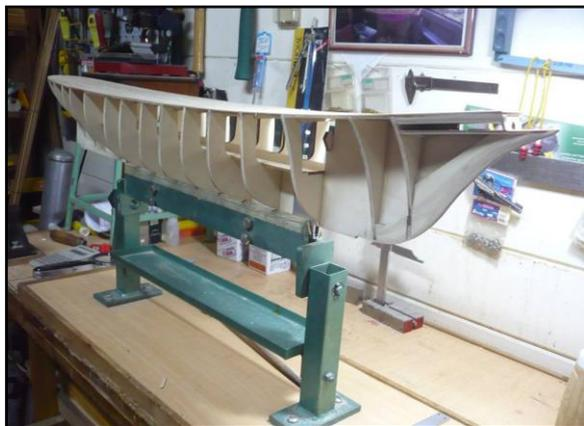
El modelo ya presenta la cubierta traqueada y lijada, todos los refuerzos encolados y desbastados listos para recibir el forrado del casco (traqueado).
