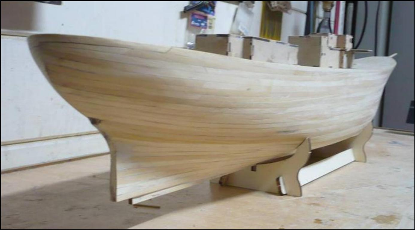
Por último en esta entrega hay que realizar otra corrección con respecto al modelo del kit y es en la terminación que presenta el casco en la sección de proa a la altura del bauprés. En el modelo de la secuencia fotográfica, se agregó una vez que se terminó de hacer el forrado, pero también se puede hacer a medida que se realiza el traqueado y luego recortar el exceso. Se acompaña un sector del plano de la Fragata en donde se marcó con una línea roja la forma que debe tener el lateral de proa.
