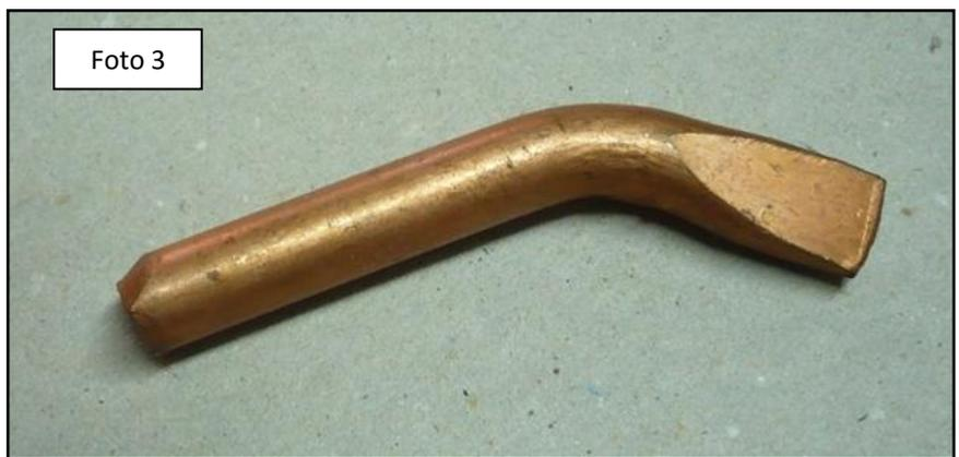
Elementos necesarios; soldador eléctrico 160 W , foto 1; planchuela aluminio mm.100 x 55 x13, foto 2; cobre de 12,7 mm ( puntero soldador enderezado, foto 3; 2 tornillos de 3/16 w, chapa aluminio de 2 de 1mm y de 0,5 ( recortes ) según necesidad estas determinaran el ancho de la ranura,
