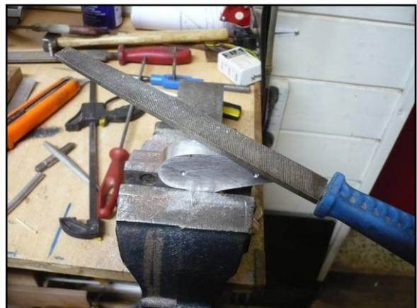
Practicar el orificio en la pieza de aluminio para introducir a presión el puntero soldador de cobre
