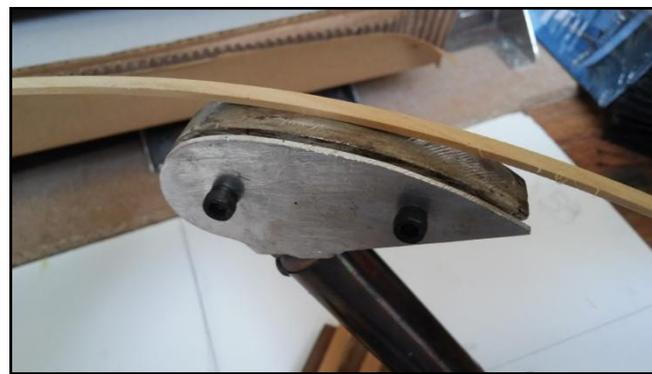
Dependiendo del espesor de la traca que se dobla, se agregan o se sacan pláncelas de suplemento.
