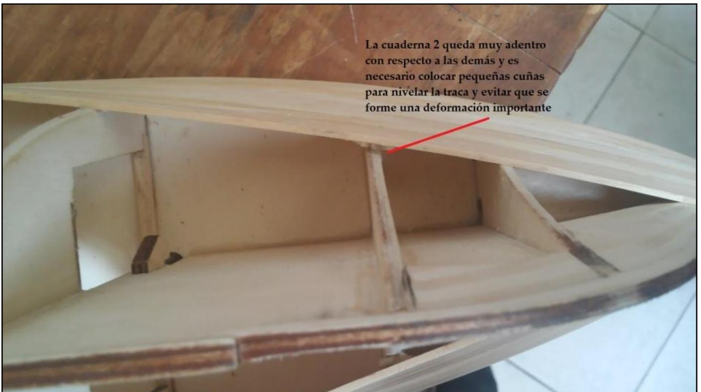
La cuaderna 2 queda muy adentro con respecto a las demás y es necesario colocar pequeñas cuñas para nivelar la traca y evitar que se forme una deformación importante
