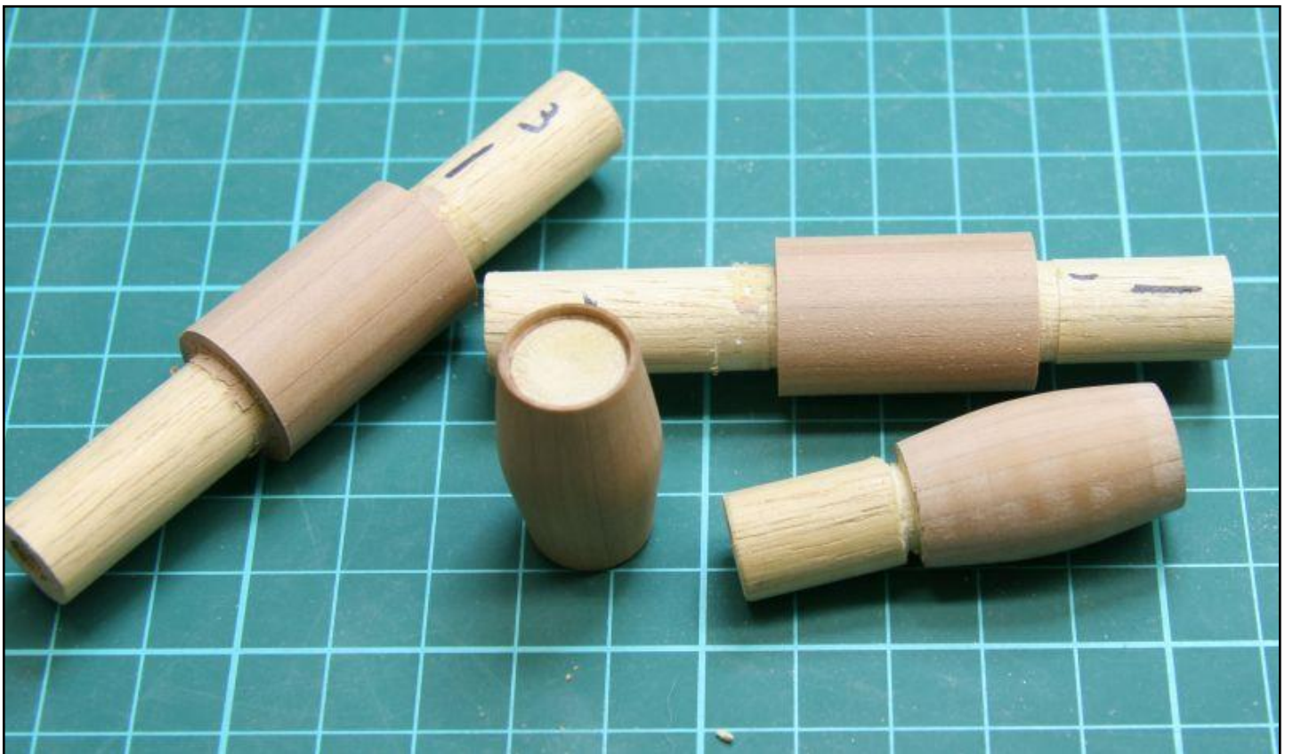
Dos tacos con un cilindrado previo y dos barriles terminados, obsérvese que también tornearon los extremos de las piezas para poder insertar las tapas.
