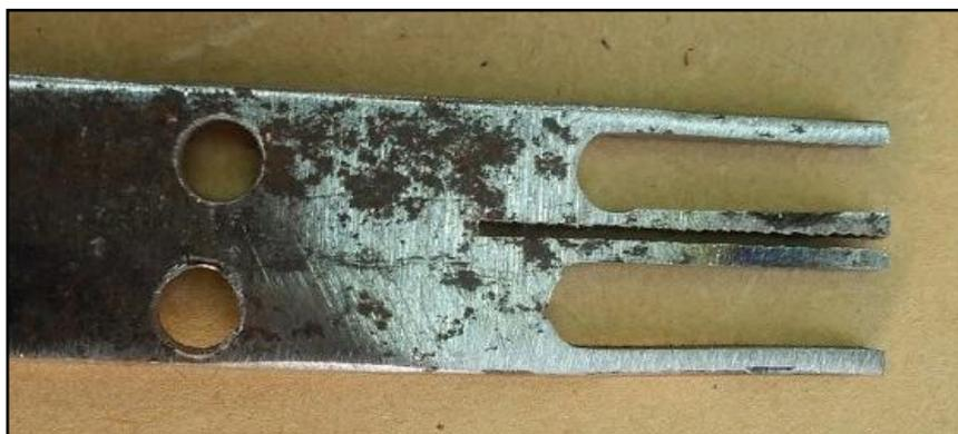
Clocando la pieza en un tornillo de banco, se hacen cortes con una sierra para metales.
