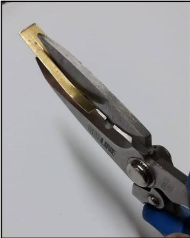
Este otro método utiliza una pinza, en lo posible de esas que están ya en desuso, a la que se le realiza una perforación para poder prensar una tira de latón alrededor de un alfiler o alambre.
