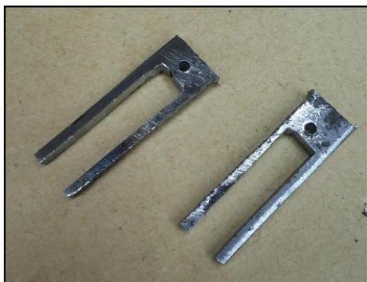
Con una pequeña mecha se hacen perforaciones donde se colocarán los pernos de la bisagra y luego terminar el interior de la bisagra con limas
