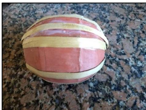
El siguiente paso consistió en cortar tiras de madera de encharpar de guatambu para hacer as duelas y comenzar el forrado externo del casco
