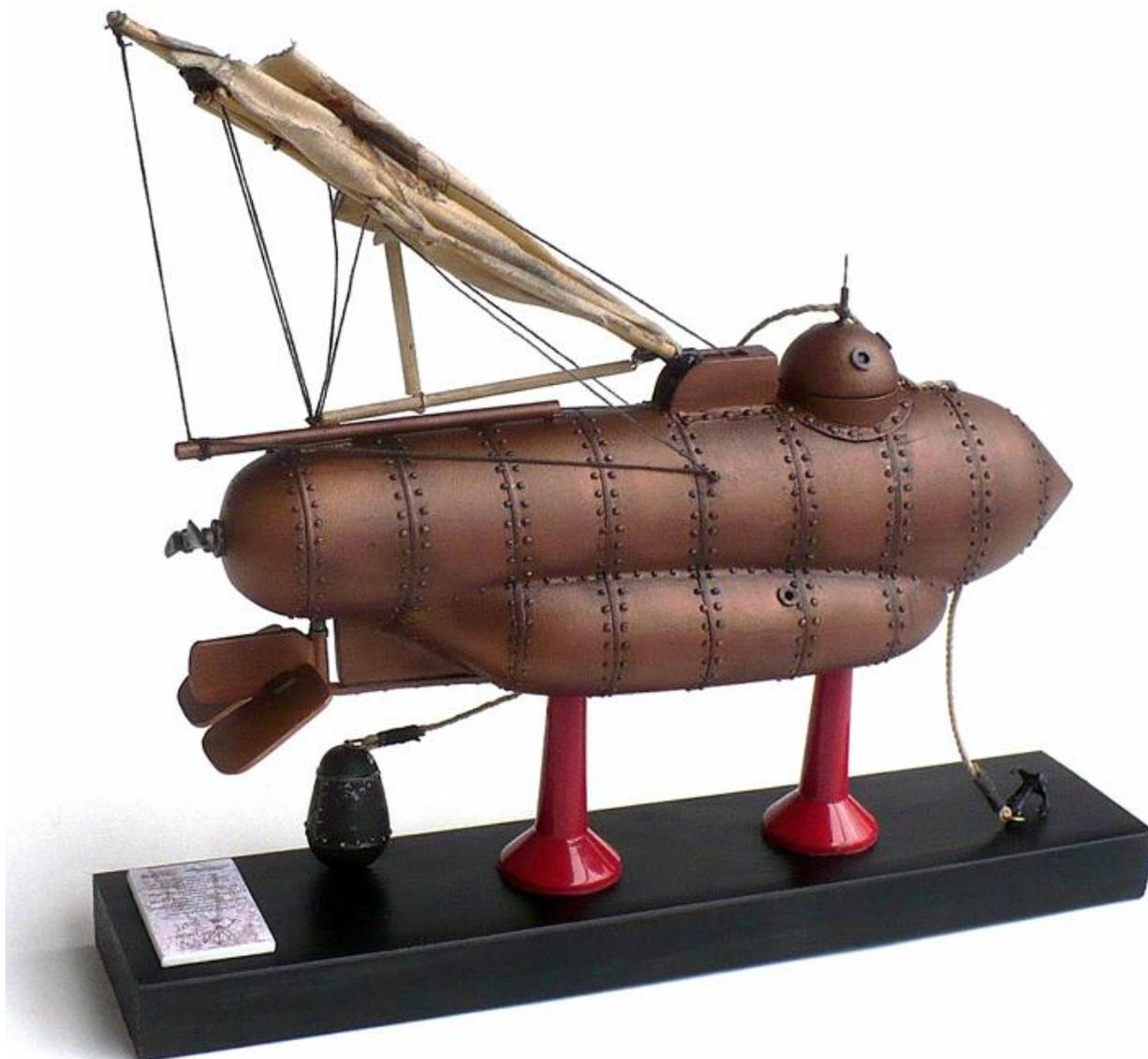
La estructura del Nautilus estaba realizada de hierro, con planchas de cobre formando el recubrimiento exterior, seguramente para evitar el problema de la corrosión y las adherencias y fue probado por primera vez en el río Sena en el año 1800. Al año siguiente, en el puerto de Brest, estuvo sumergido durante más de una hora y fue capaz de hundir una balandra de 12 metros tras alcanzarla con una carga explosiva instalada en el extremo de un botalón.
