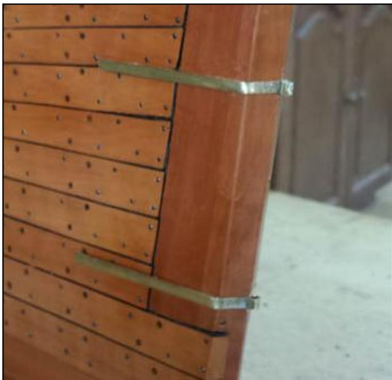
Determinada la posición de cada una de las bisagras, se realizan con mecha muy fina las perforaciones para los clavos que sujetan las bisagras al casco y al timón.
