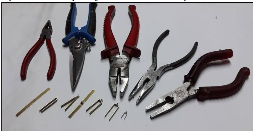
*Bisagras con lámina de latón soldadas con estaño o plata*
