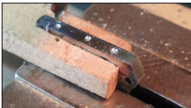
Para perforar los orificios donde pasaran los clavos, primero se practicó con mecha de centrar las marcas para que la mecha para metales no se rompa o se salga del lugar donde se quiere perforar. Si no se tiene una mecha de centrar se puede marcar con una punta de marcar.
