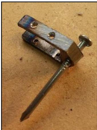
Para el eje simplemente se usa un clavo. Se corta la cabeza del mismo con un alicate y paso siguiente se coloca nuevamente en el tornillo de banco para remachar el extremo para que no se salga del brazo de la bisagra.
