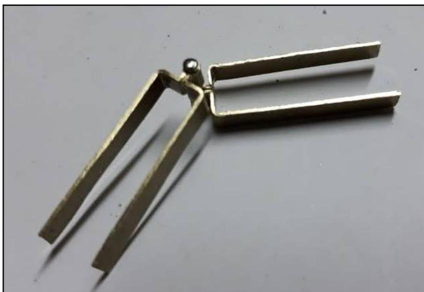
Solo falta cortar a la medida los brazos de bisagra y realizar las perforaciones laterales por donde pasarán los clavos que aseguran las mismas al timón y al casco del barco.
