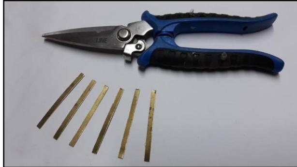
De una lámina de latón y usando una tijera para chapa, se cortan tiras del mismo ancho de la bisagra y cuya medida se saca del plano.
