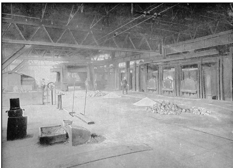
*Foto 3: En las modernas factorías y fundiciones, se comienza el fundido del bloque de acero especial que será el núcleo del cañón*
