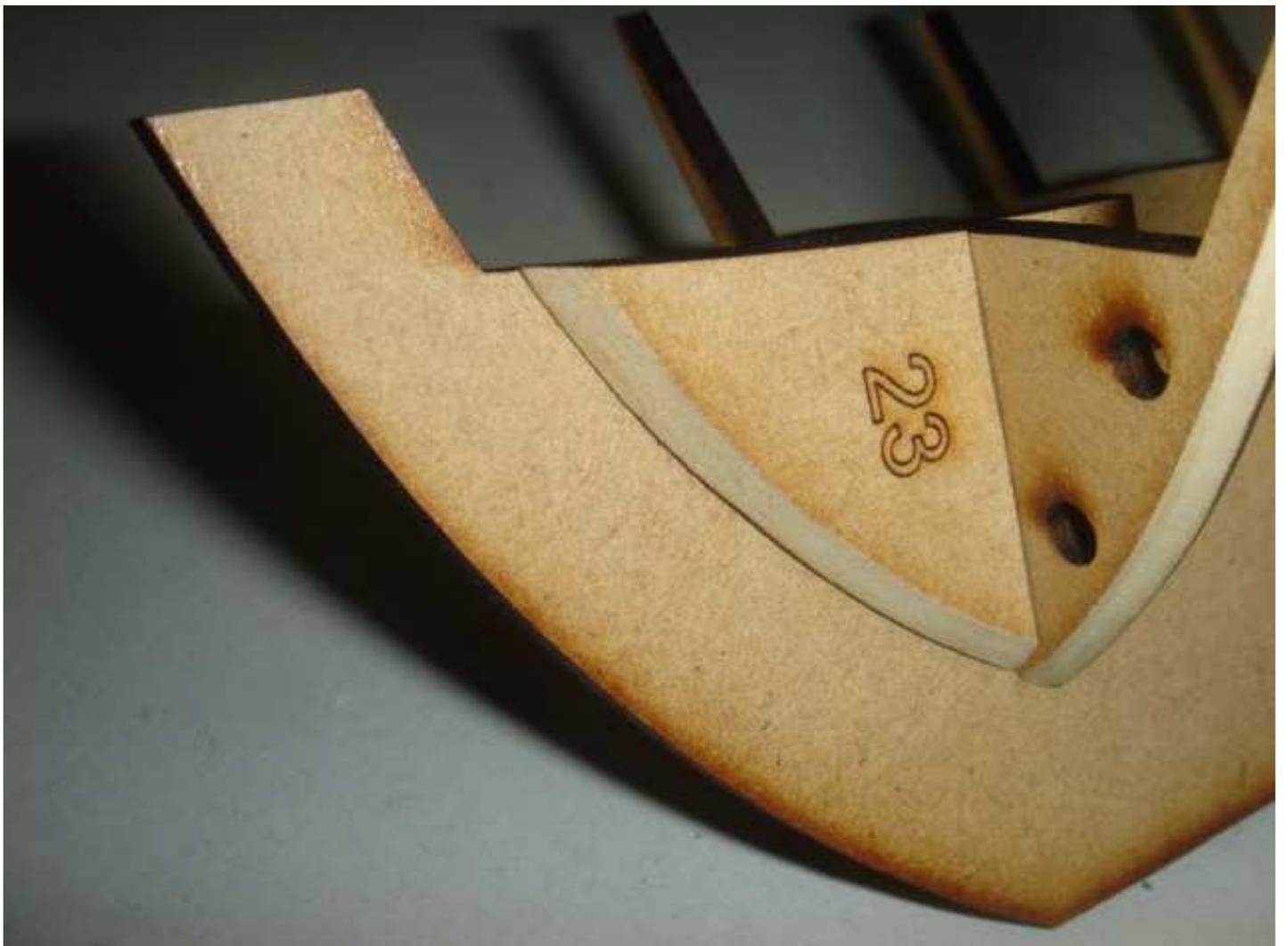
Foto 8: Primer mamparo presentado junto al soporte delantero que facilitará el pegado de las tracas del forro externo del casco.
