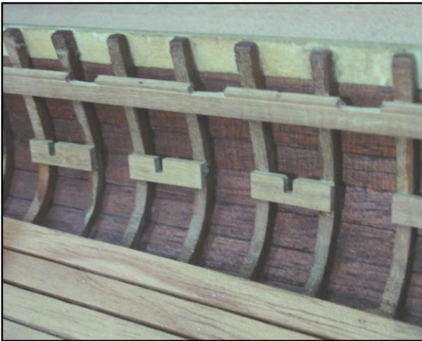
Se fijaron a los añadidos de las cuadernas, los bloques de apoyo de los escalones y los contradurmientes. Estas piezas se fabricaron en lapacho. Posteriormente se simulon los clavos con alambre de cobre de .5mm.
