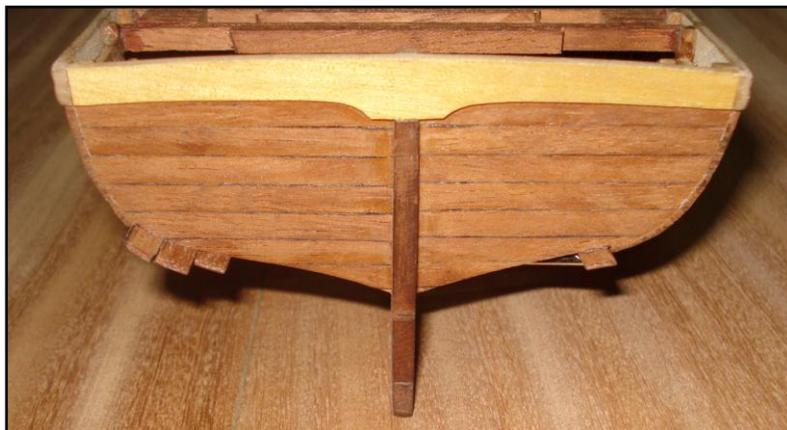
El espejo de popa se forró con listones de cedro, los cuales se insertaron en el alefriz vertical realizado previamente en el codaste y apoyados sobre la cara posterior de la última cuaderna. Se simularon los clavos con alambre de bronce de 0.5mm de espesor.
