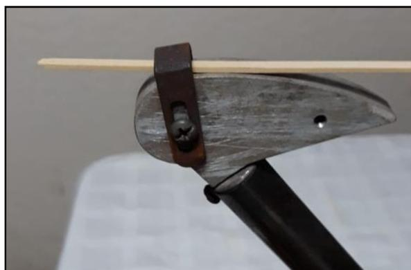
El proceso es muy sencillo, se moja la traca algunos minutos, luego se apoya sobre el dobla tracas caliente y se comienza lentamente a dar forma, a medida que la traca se va secando por efecto del calor del soldador, se la sumerge nuevamente en agua y se repite la operación hasta lograr la forma definitiva.
